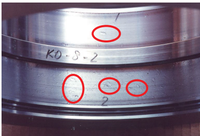
外圈轨道面的压痕
