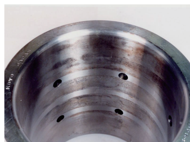
内圈内径面的磨蚀 (或称微振磨损)
