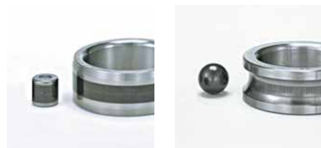
図17 一般軸受に生じた電食(ピット)
