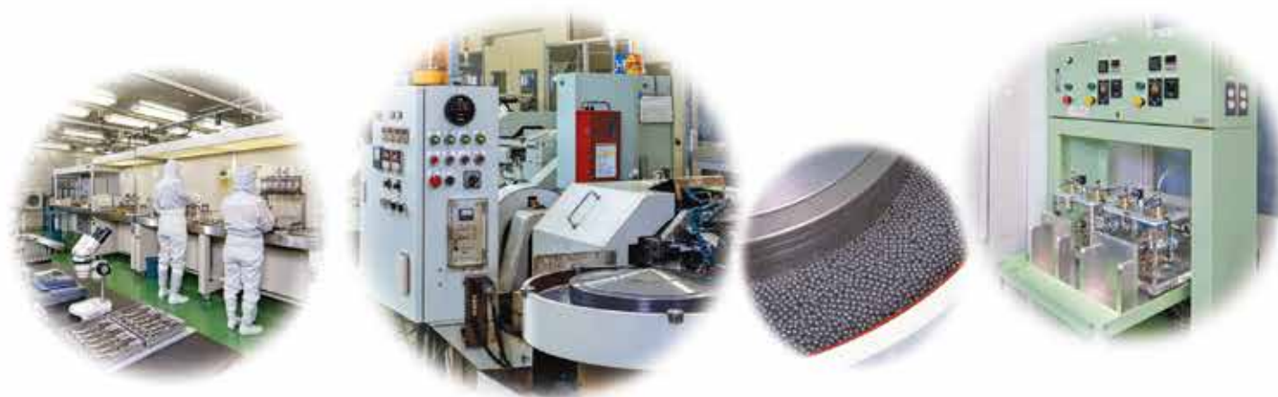
図5 転がり軸受用窒化けい素の製造工程
