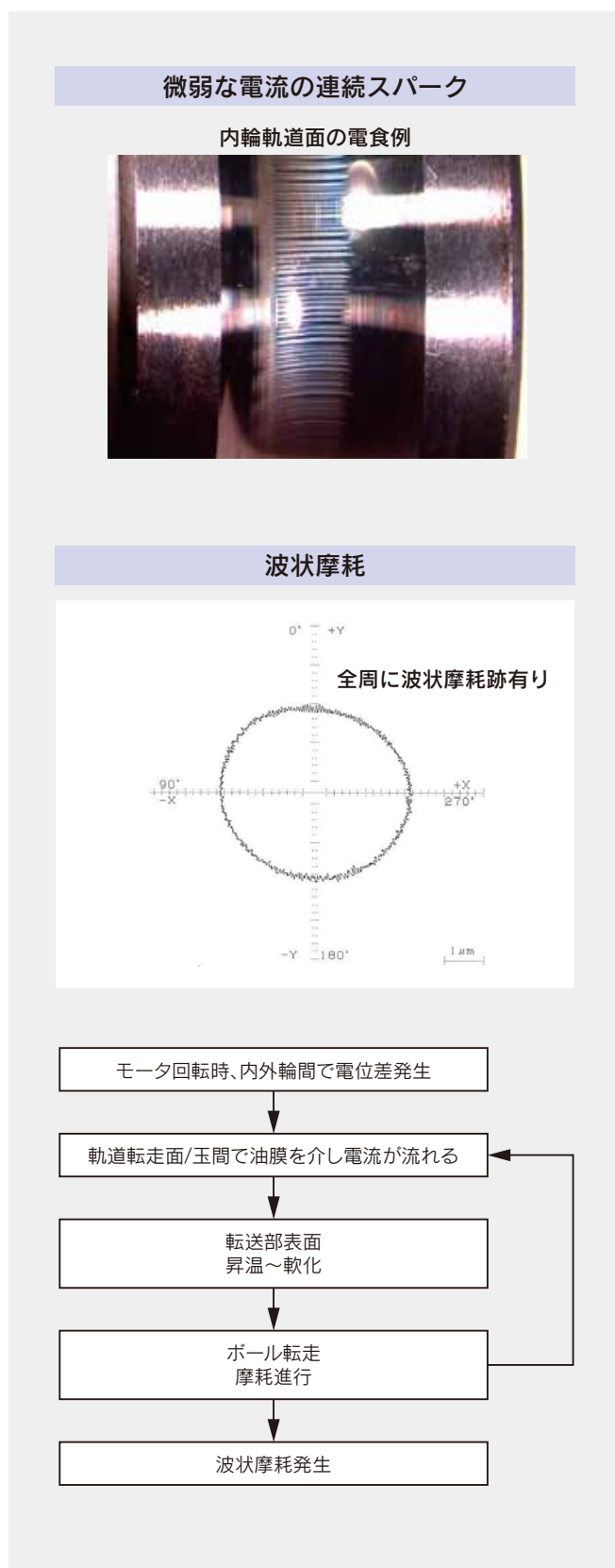
図19 電食(波状摩耗)発生メカニズムの推定
