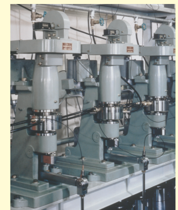
图 1-3 滚动疲劳寿命试验的条件和装置
