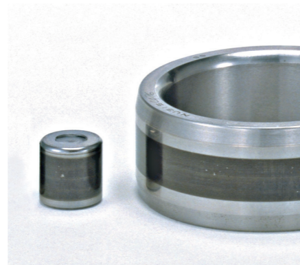
图 4-2 普通轴承上发生的电蚀（坑）
